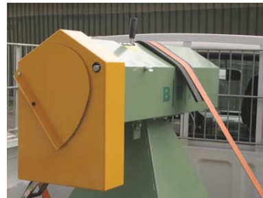
Abb. 2 Position des Zurrgurtes zur Sicherung.
