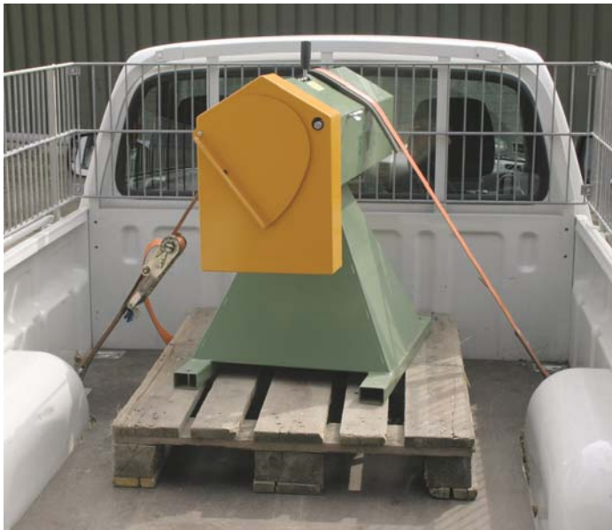
Abb. 1 Gesicherte Wacker Putz- und Fräsmaschine Typ BHI auf einem KFZ.
