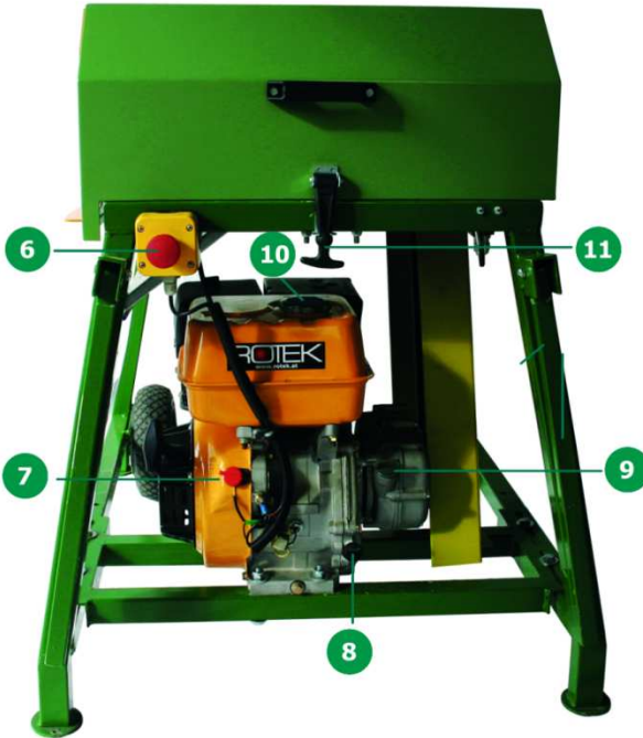
Abb. 10: Fräsmaschine, Typ V 3.K mit Benzinmotor (9 PS) - Seitenansicht
