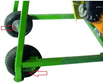
Abb. 12: Fräsmaschine in Parkposition
