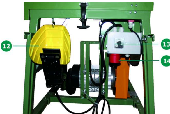
Abb. 11: Fräsmaschine, Typ V 3.K mit Elektromotor (400 V) - Seitenansicht
