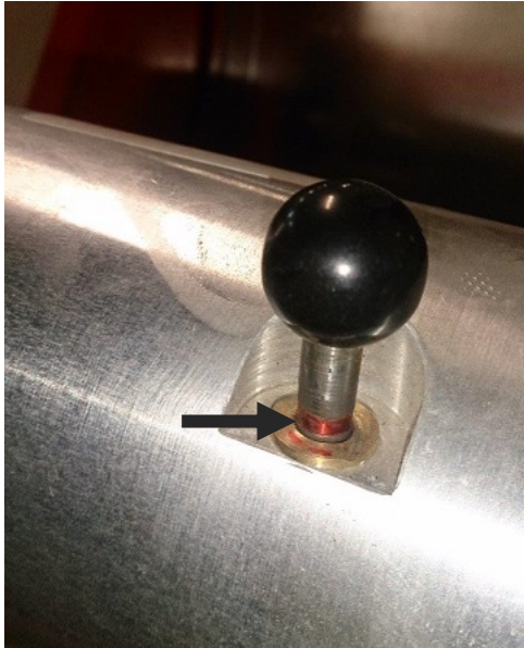
Abb.8 Rote Markierung muss sichtbar sein
