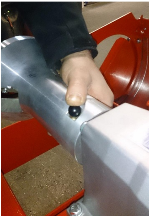
Abb. 7 Neuen Fräskopf aufschieben
